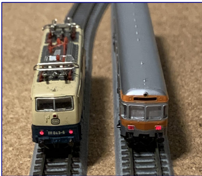
Lichtwechsel weiß / rot per LED an der Baureihe 111 wie auch am Steuerwagen. Fotos: Alexander Hock
