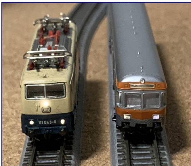
Lichtwechsel weiß / rot per LED an der Baureihe 111 wie auch am Steuerwagen. Fotos: Alexander Hock
